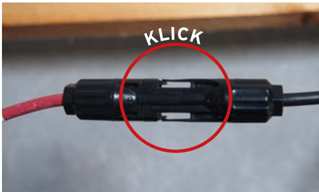
WICHTIG! Achten Sie beim Verknüpfen von Steckverbindern darauf, dass diese ineinander einrasten!
